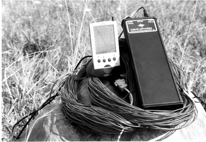
Kuva 2. TEM-Fast 48 HPC mittalaite lähetinkaapelien ja kämmenmikron kera (kuva: http://www.aemr.net ).
