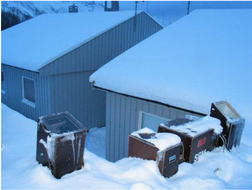
Kuva 1: Vasemmalla PC-ohjattu CCD kamera AP7, keskellä viisikanavainen pyyhkivä fotometri ja oikealla kaksikanavainen zeniittifotometri. Laitteet on asennettu Tromssan Eiscat-asemalle revontulimittauskampanjan ajaksi.
