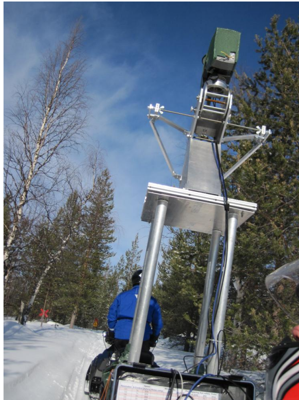
Kuva 1. ROAMER, Geodeettisen Laitoksen liikkuva laserkeilauslaitteisto asennettuna moottorikelkan rekeen.
