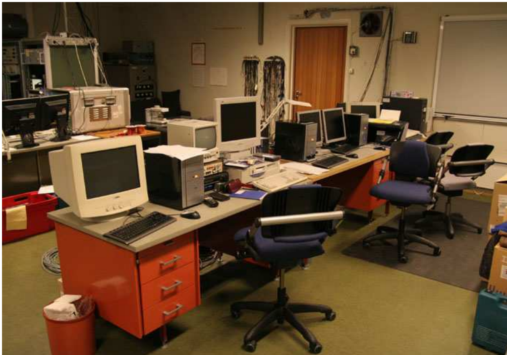
Kuva 2: Kahden fotometrin, kahden spektrometrin ja revontulivideokameran ohjausmikrot Tromssan Eiscat-asemalla revontulikampanjan aikana.
