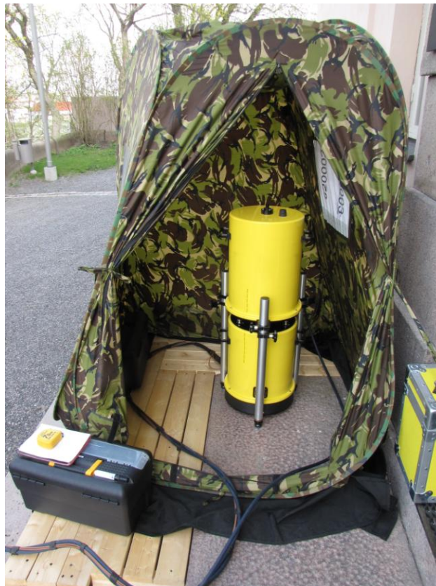
Kuva 2. A10 absoluuttigravimetri Turun vartiovuorella. Laitteen painovoimamittauksen vertailukorkeus on 68 cm.
