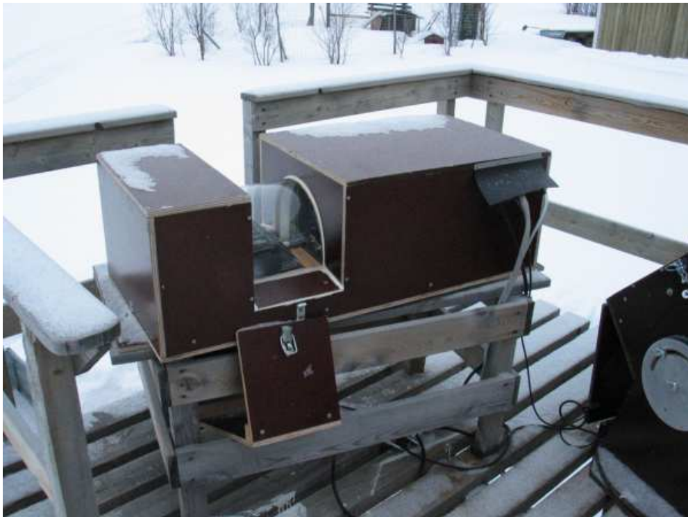
Kuva 4: Pyyhkiä kuusikanavainen fotometri Karesuvannon revontuliasemalla. Oikealla CCD-kamera AP7.
